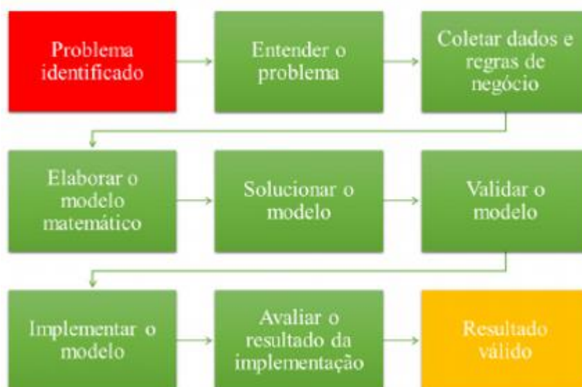
Figura 4 – Fluxograma desenvolvido para a modelagem e resolução do problema. Fonte: adaptado de Hillier e Lieberman (2012).
