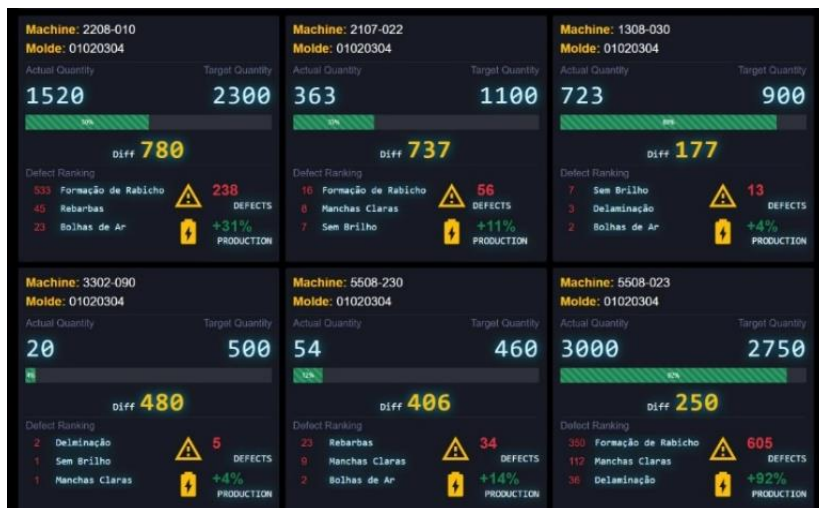
Figura 2 – Display evidenciando os dados coletados das máquinas Fonte: ISM.
